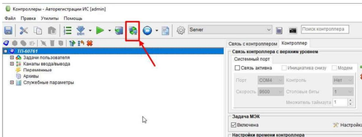
После перехода в режим опроса открываем вкладку «Контроллер». Нажмём на кнопку «Регистрация ИС EnLogic»
